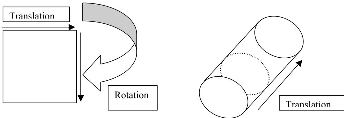
**Abbildung 13: Erzeugung eines Quadrats und eines Zylinders.**
