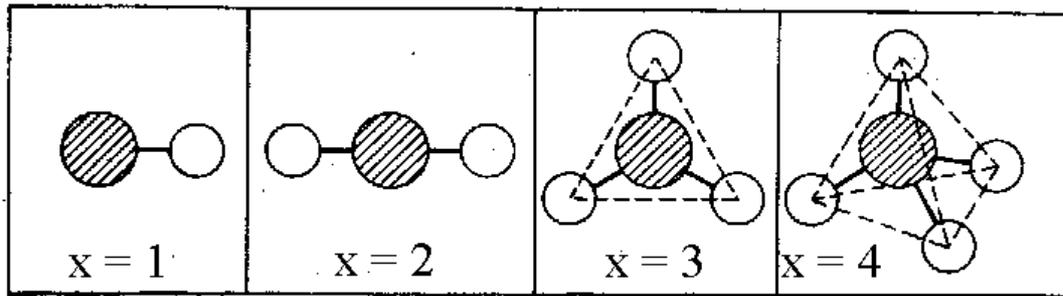
**Abbildung 11: Geometrische Struktur der Ionenmoleküle mit der Zusammensetzung  $Abx$  (vgl. Wolff, 1963: 35).**
